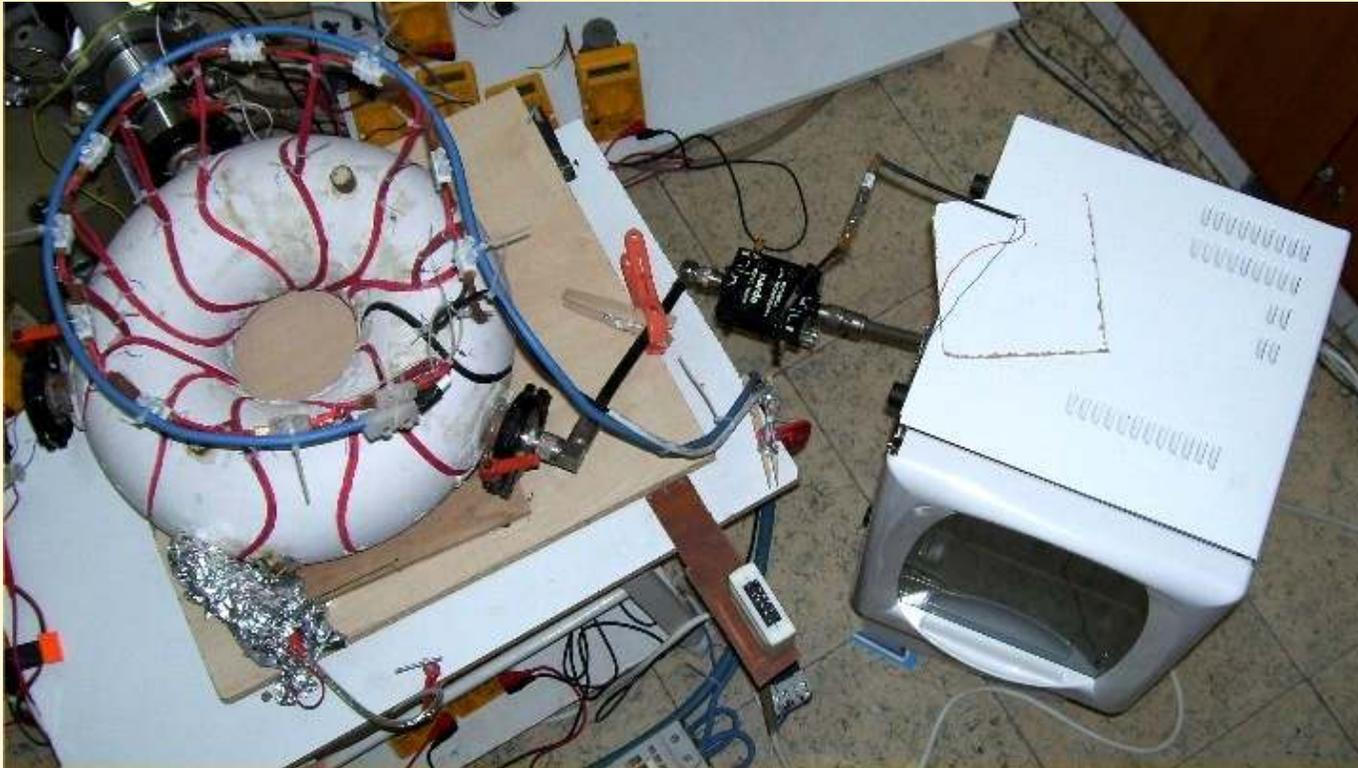
Se observa : un horno de microondas común, líneas coaxiales de transmisión de microondas, medidor de potencia, antena(no visible, dentro de UST\_1 )
