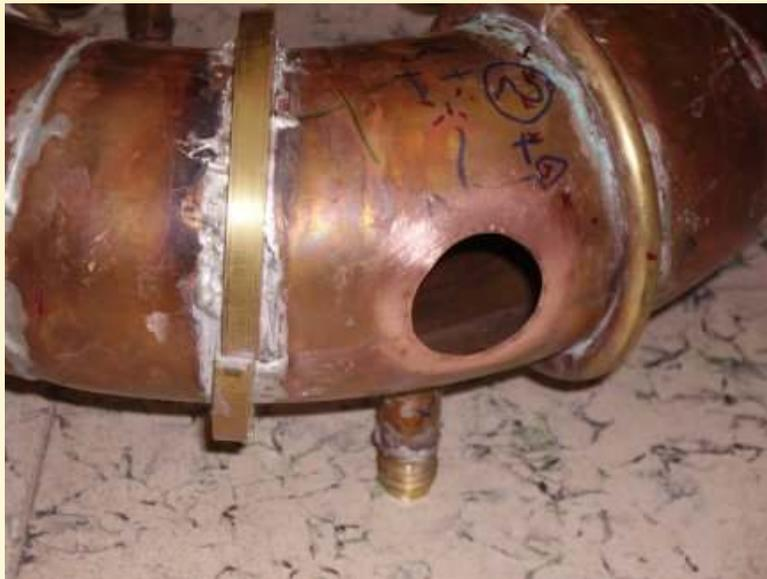
Detalle, perforación para una boca y dos anillos para reforzar la cámara
