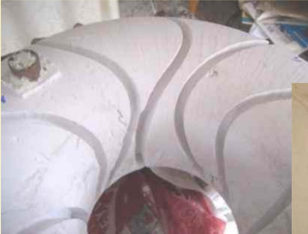
**1** ◀ Surcos mecanizados en el marco compacto de escayola, ancho 7mm, profundidad 12.5mm. Precisión  $\pm 0.3\text{mm}$
