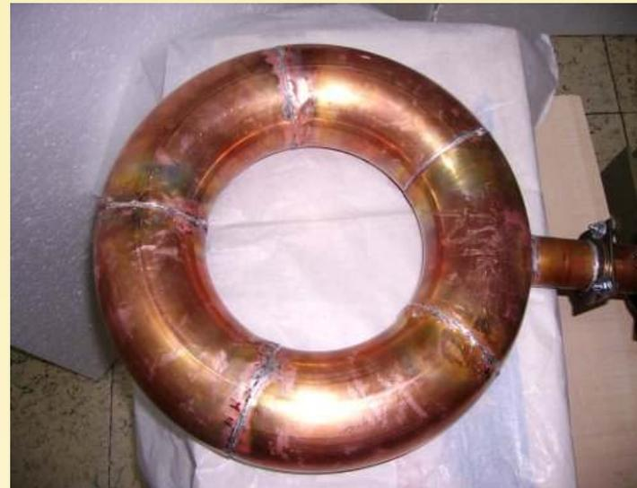
◀ Cámara de vacío formada por 5 codos de 75°. Tubo 80mm diam. R-toro 119mm. Soldado con plata-Sn al 5%
