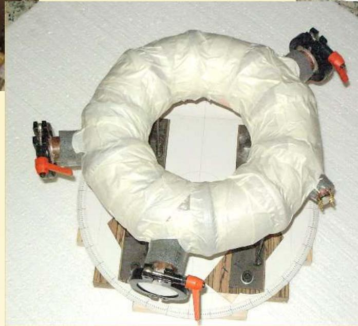
**3** Cámara de vacío recubierta de capa flexible y hermética
