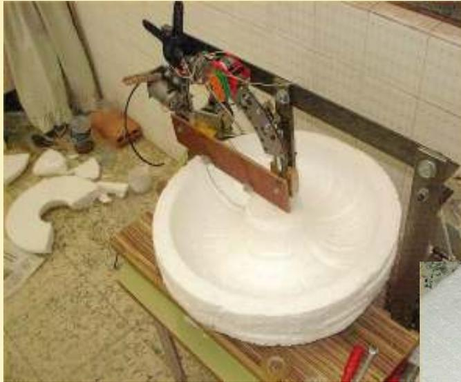
**1** Mecanizando el molde de corcho blanco para la escayola. Semicírculo de alambre caliente girando sobre un eje
