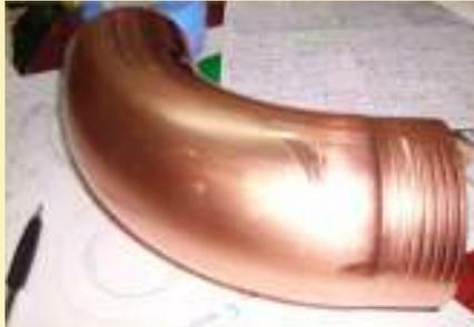
Codo de cobre. Pared de 0.8mm de espesor
